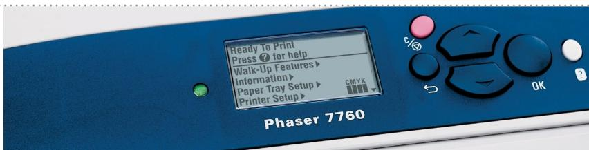
Interfață de control cu ecran în sase linii vă oferă acces rapid la toate funcțiile de imprimare și soluțiile ajutătoare necesare.
