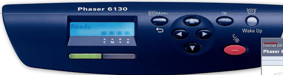
Verificați rapid nivelurile de toner pe afișajul panoului frontal al imprimantei sau pe ecranul computerului.
